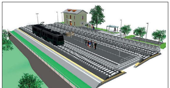
Die Bahnsteigausstattung für den card\_1 Bahnsteiggenerator erfolgt flexibel über 2D-Symbole, die anschließend in 3D generiert werden.
