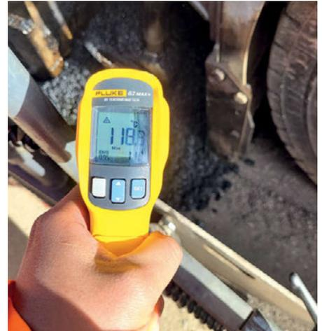
Abb. 6: Temperaturmessung mit Infrarotthermometer im Gleis 1
