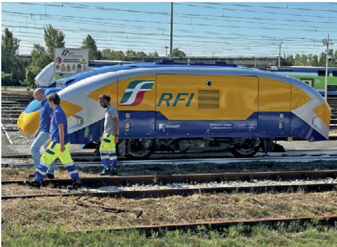
Das autonom fahrende Inspektionsfahrzeug
