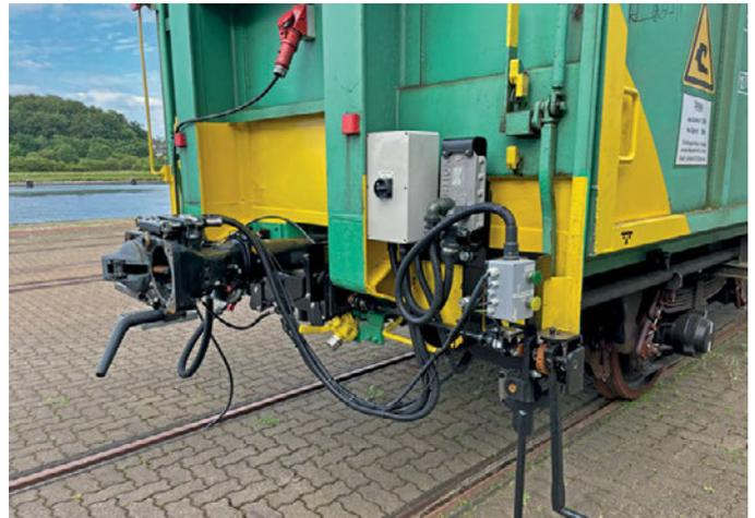
Aktuelle DAK Typ 5 von Voith an einem Testwaggon
