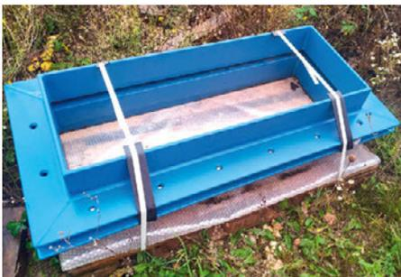
**Abb. 3:** Adapterrahmen (Ankervorrichtung) mit Löchern für Senkkopfdübel
