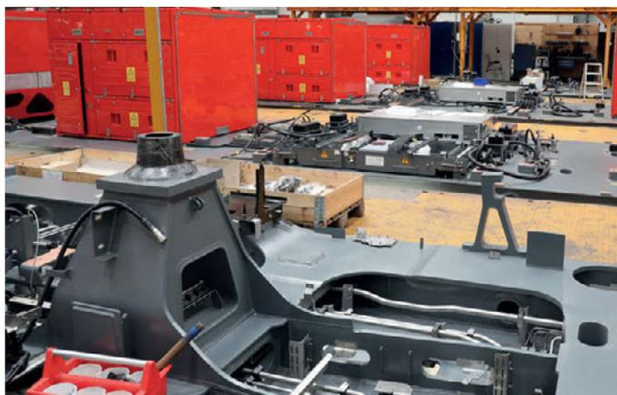
Produktion der HDB 800: vorn Lok 7 (gedrehter Lokrahmen), dahinter die Lokomotiven 4 bis 6
