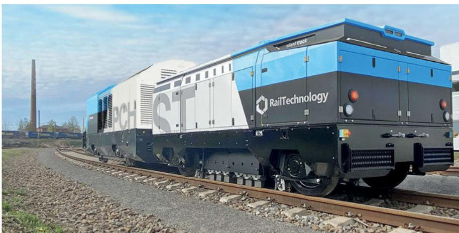
Fahrzeug zum Silent-Track-Hobelschleifen
