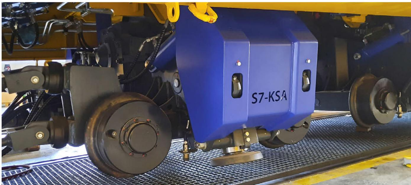
Abb. 2: Kontrolliertes Stabilisieraggregat (KSA)
