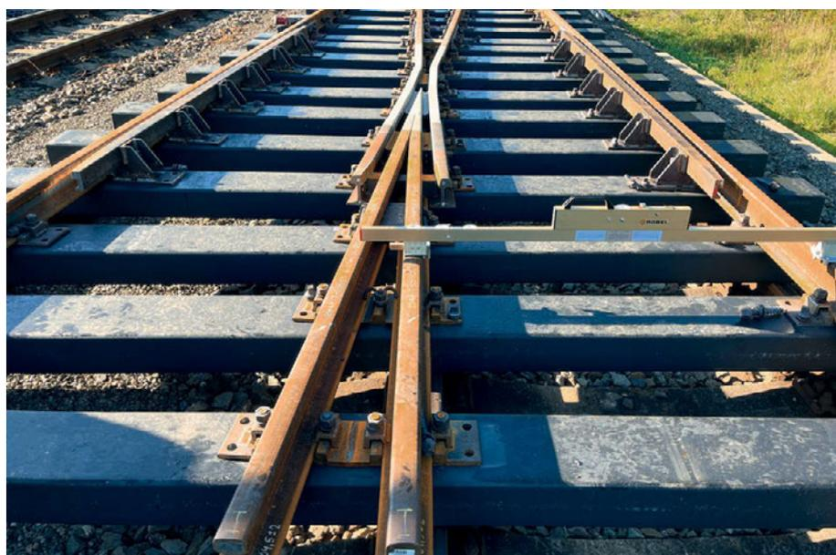
**Abb. 4:** Die Kunststoffschwelle Strailway 30 ist für eine Achslast von 16 t sowie für die auf Nahverkehrsstrecken übliche maximale Zuggeschwindigkeit von 120 km/h ausgelegt.
