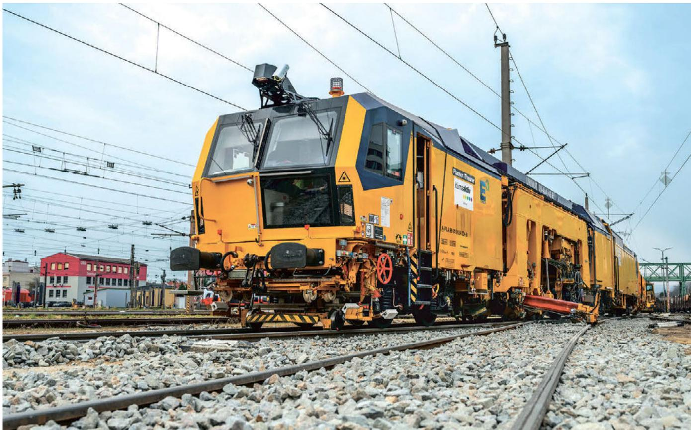
Abb. 1: Mit modernsten Assistenzsystemen ausgestattete Universalstopfmaschine bei der Arbeit
