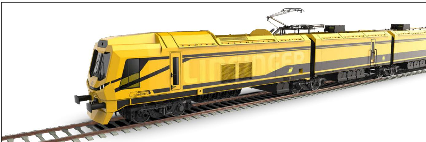
Der modular aufgebaute Schienenfräszug Railmaster
