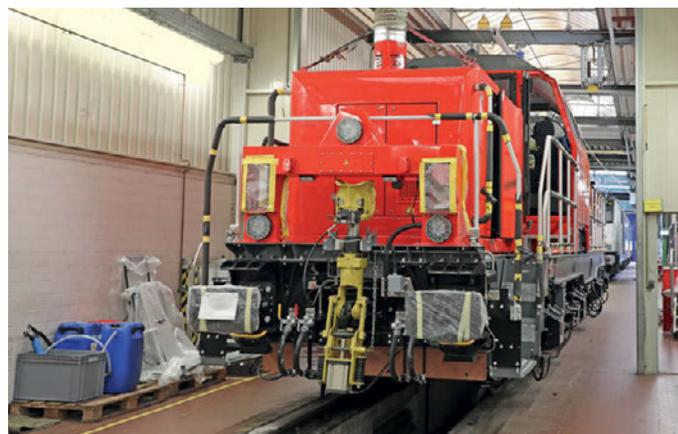
Inbetriebnahme der HDB 800 bei Talbot Services, ungewöhnlich die Abgasführung der Gen-Sets an den beiden Fahrzeugenden
