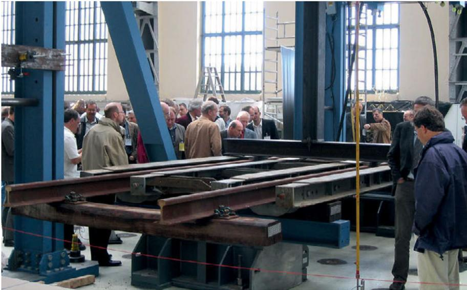
**Abb. 3:** 2. Fachtagung KIB in der TU Berlin – Versuchsstand zur Messung einer Kleinhilfsbrücke unter dynamischen Lasten
